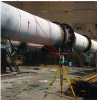
Рис. 1. Принцип измерения печей электронным тахеометром
