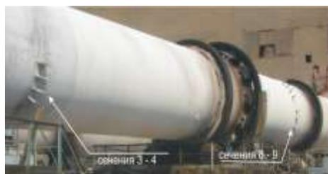
Если сравнить полученные данные с результатами визуального обследования печи (рис. 3) видно, что печь была усилена в местах появления трещин специальными конструктивными элементами - ребрами жесткости, которые усиливают обечайку и препятствуют развитию деформаций изгиба печи.
